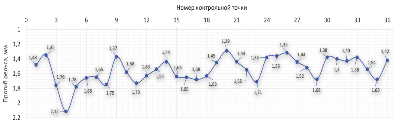
Рисунок 7 – Прогибы рельса конструкции Feste Fahrbahn Voegl
