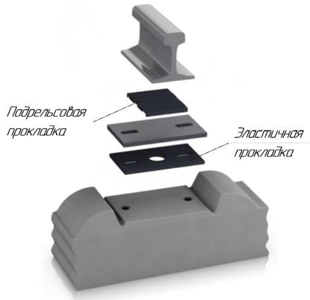
Рисунок 1 – схематичное изображение прокладок в узле скрепления
